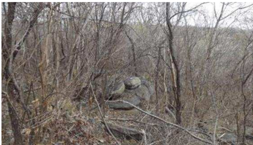
Foto 3.4- Vertedouro: Granito aflorante na forma de lajedos escalonados exibindo foliação subhorizontal Sn 270az/5. Estaca 7 do vertedouro. Rocha são (E=353.822,942; N=9.530.005,628), novembro/2019.
