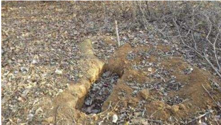
Foto 3.1- Caixa de amostragem de solo, evidenciando pouca espessura de regolito na região do eixo (F-34) (E= 354.551,913; N= 9.529.546,728), novembro/2019.
